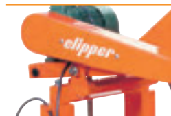
Główka tnąca ma regulowaną wysokość.
