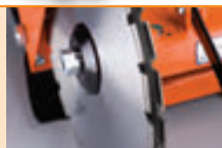
Montowanie bliźniaczych tarcz.
